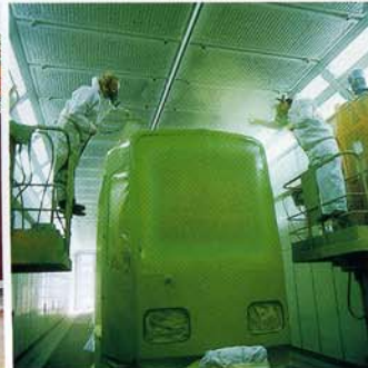
Nelle linee di verniciatura e per compiti speciali, gli apparecchi MAGNUM della WIWA esprimono la loro forza come pompe d'alimentazione con più pistole a spruzzo.
